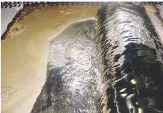
Crisol con soldadura libre de plomo con MS2™, mostrando que no hay escoria y una soldadura brillante.
