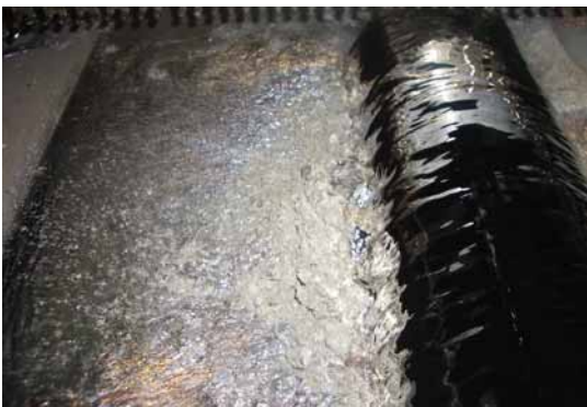
Crisol con soldadura libre de plomo sin MS2™, mostrando la típica capa de escoria.
